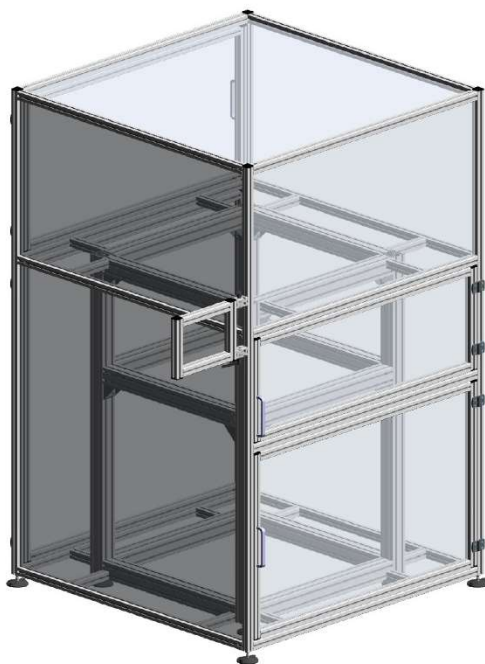
Obr.46 – poslední verze konstrukce z hliníkových profilů
