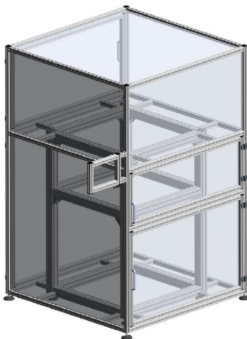
Obr.46 – poslední verze konstrukce z hliníkových profilů
