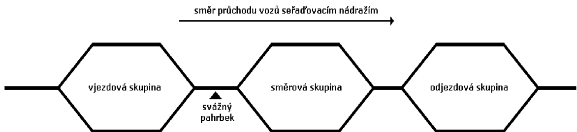
Obr. 2.1 Schéma koľajových skupín zriaďovacej stanice
