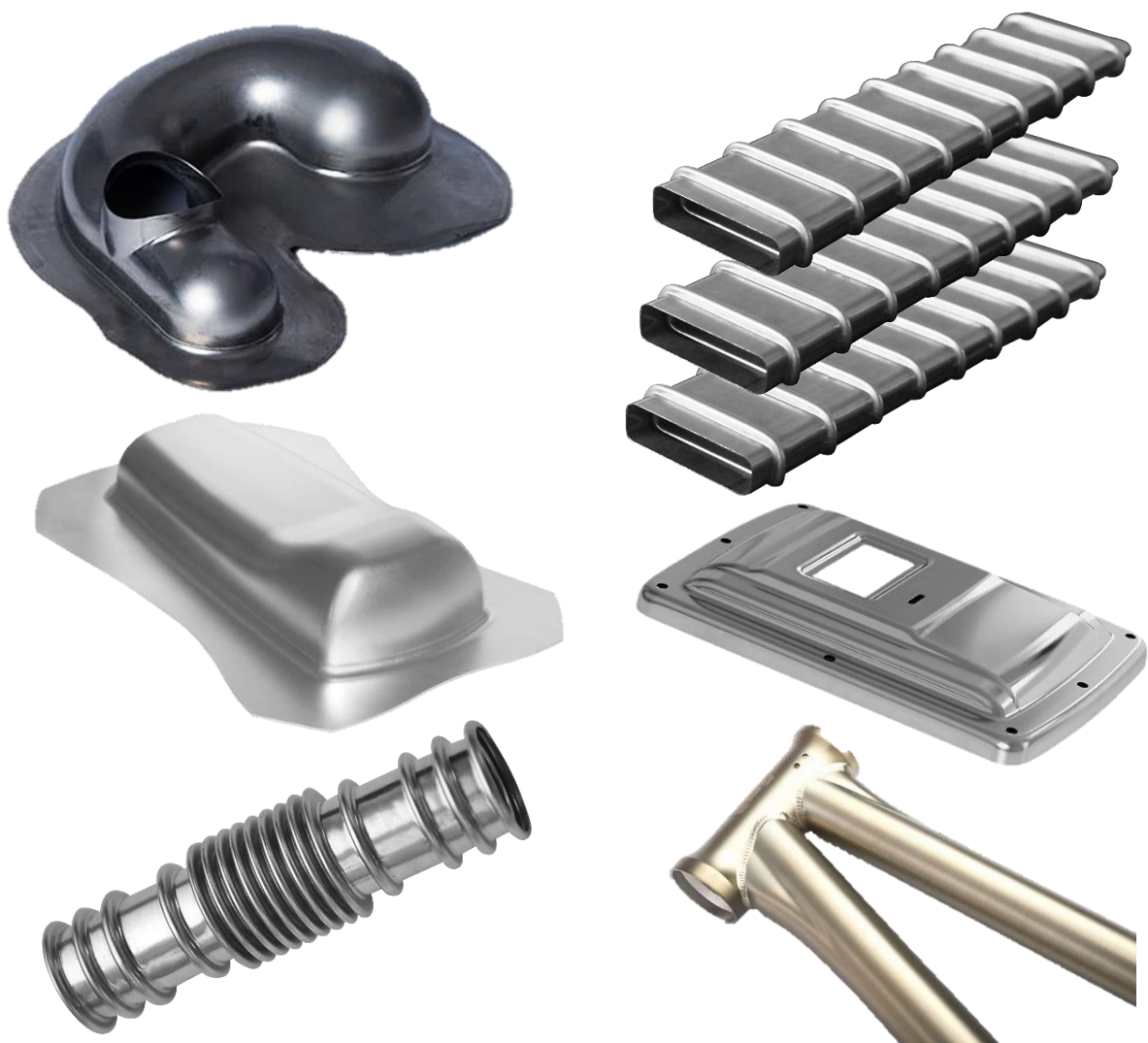
Obr. 1 Príklady dielcov vyrobených technológiou hydroformovania [4, 5, 6, 7]
