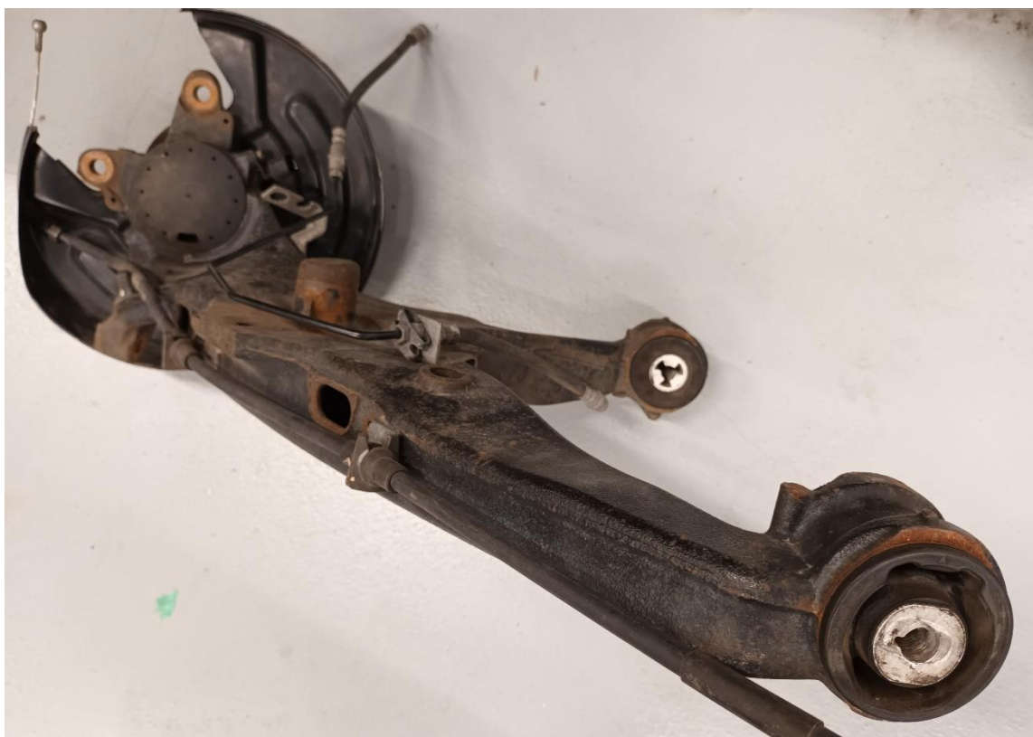
Obrázek 12 Orientace pružných lůžek v rameni
