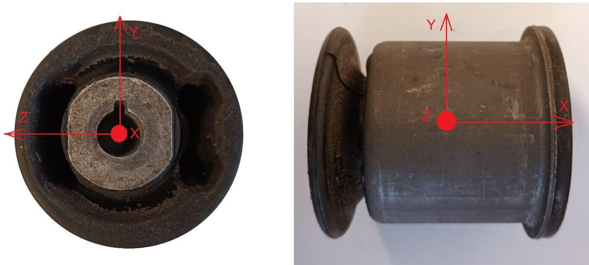
Obrázek 15 Zvolený souřadný systém pro vnitřní pružné lůžko
