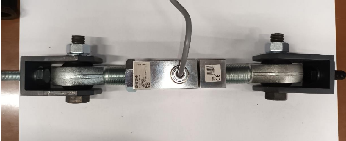
Obrázek 21 Převodník síly do 20 kN s namontovanými oky a adaptéry
