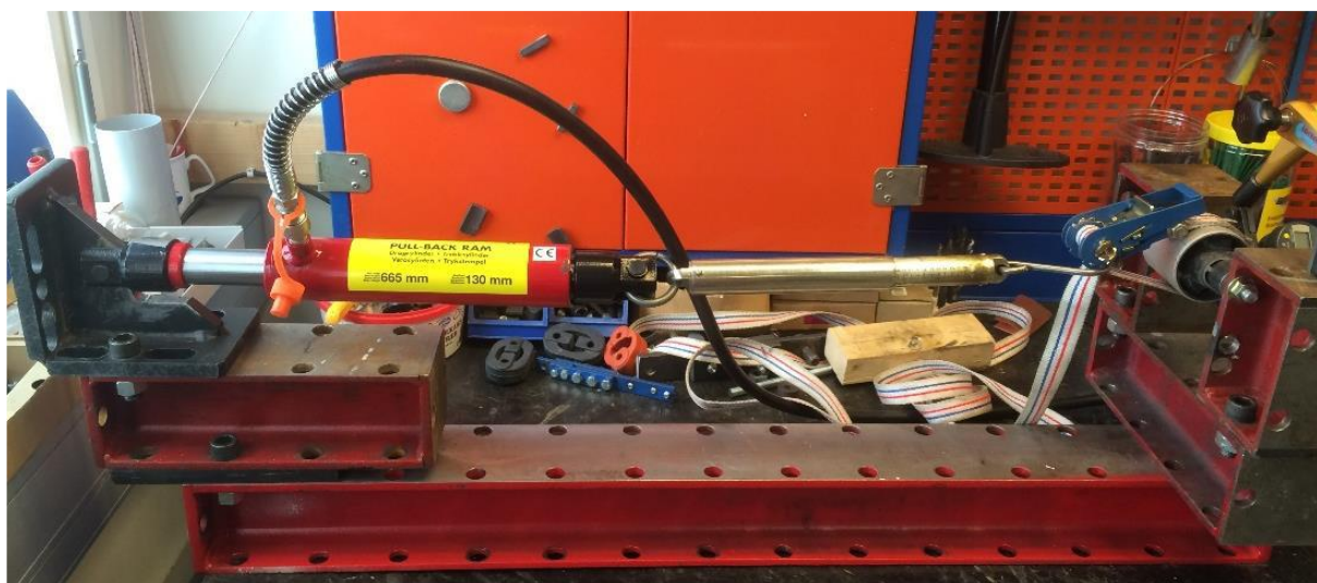
Obrázek 7 Zařízení pro měření statických charakteristik při radiálním namáhání tahem [11]
