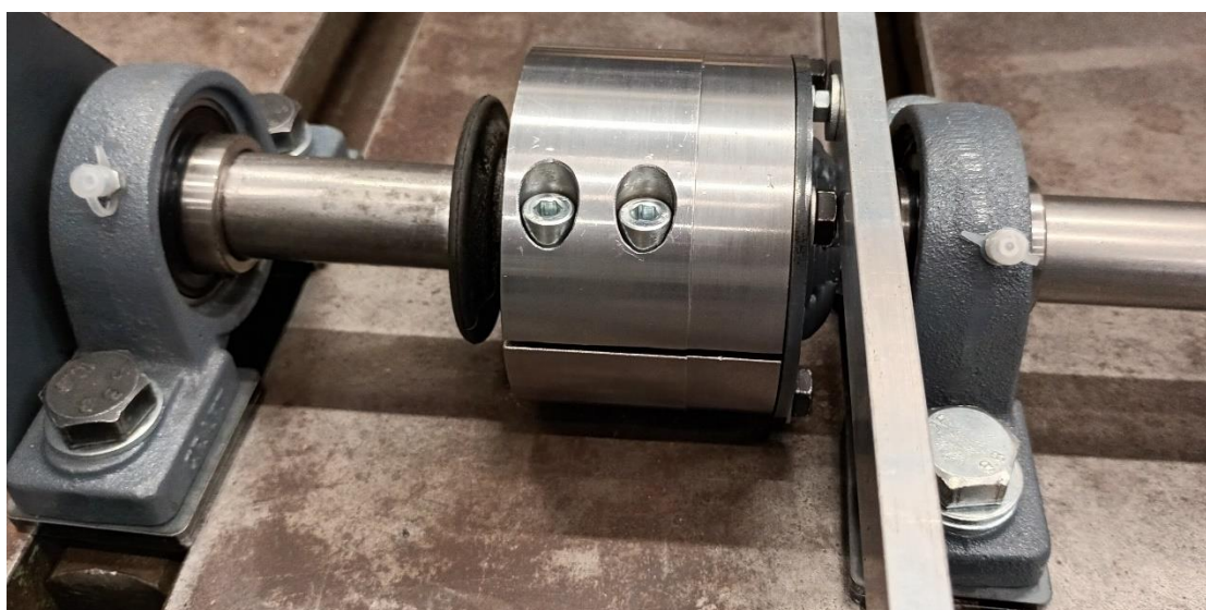
Obrázek 43 Spojení hřídele a příruby přímo bez kloubů
