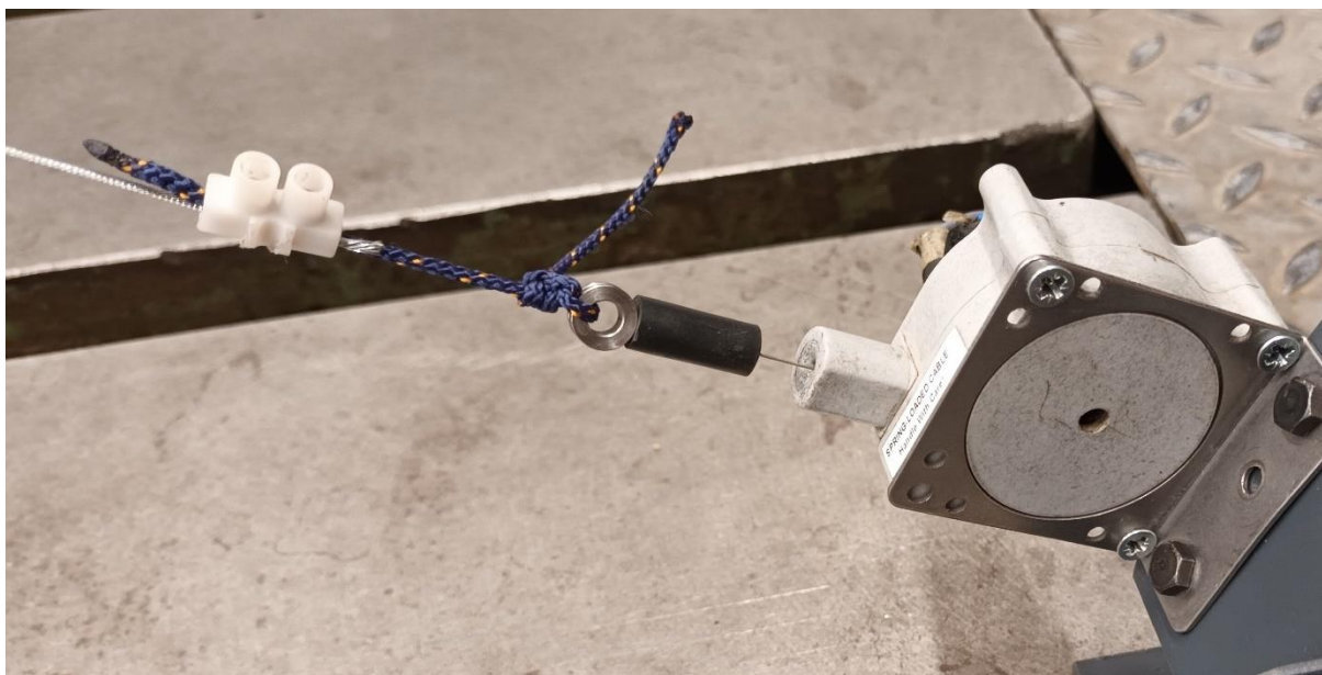
Obrázek 18 Spojení lanka potenciometru s lankem na kruhové výseči
