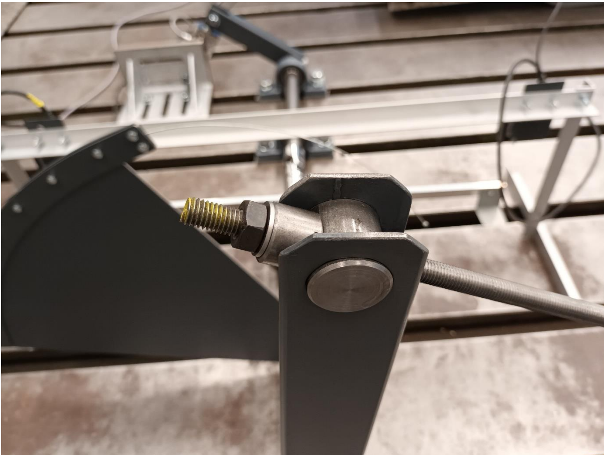
Obrázek 24 Spojení závitové tyče a páky
