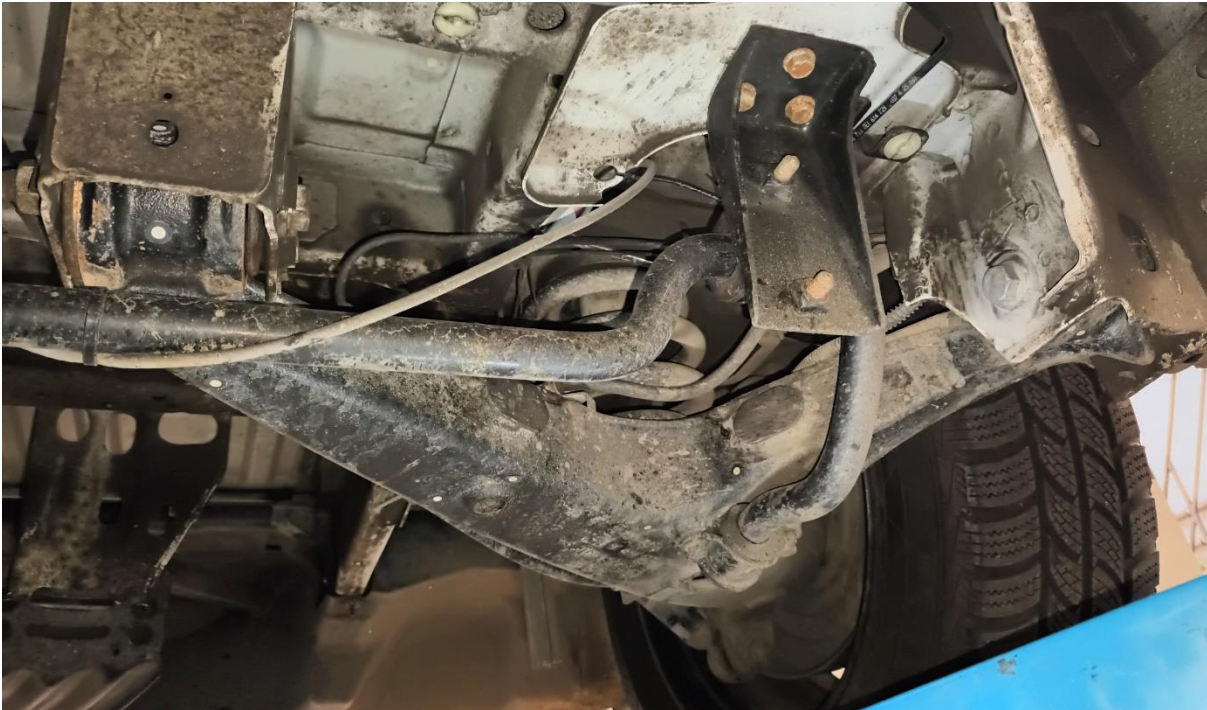
Obrázek 10 Levé rameno zadní nápravy, pohled proti směru jízdy
