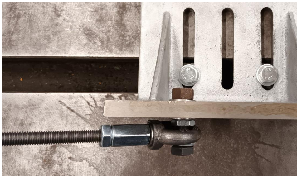
Obrázek 29 Uchycení konce závitové tyče
