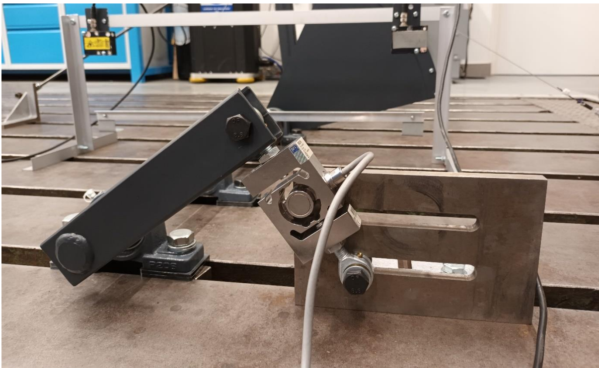
Obrázek 42 Páka a uchycení převodníku síly – pohled z boku
