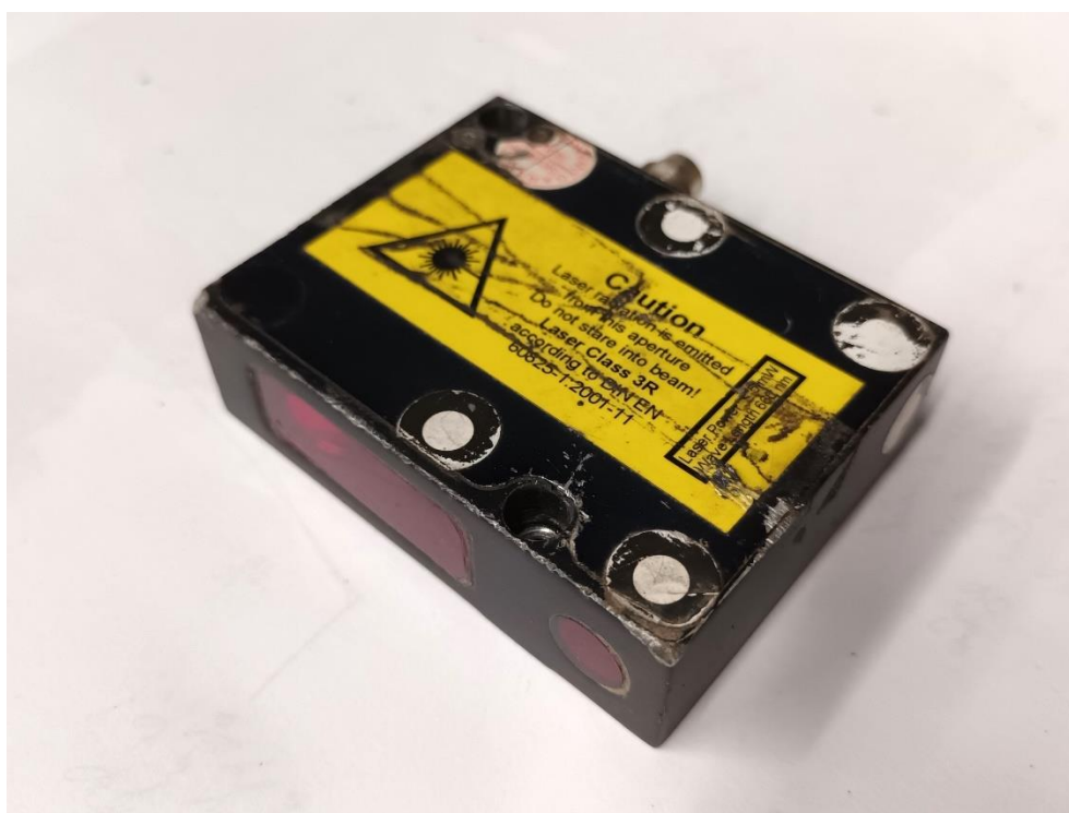
Obrázek 19 Bezkontaktní měřidlo vzdálenosti HT-250
