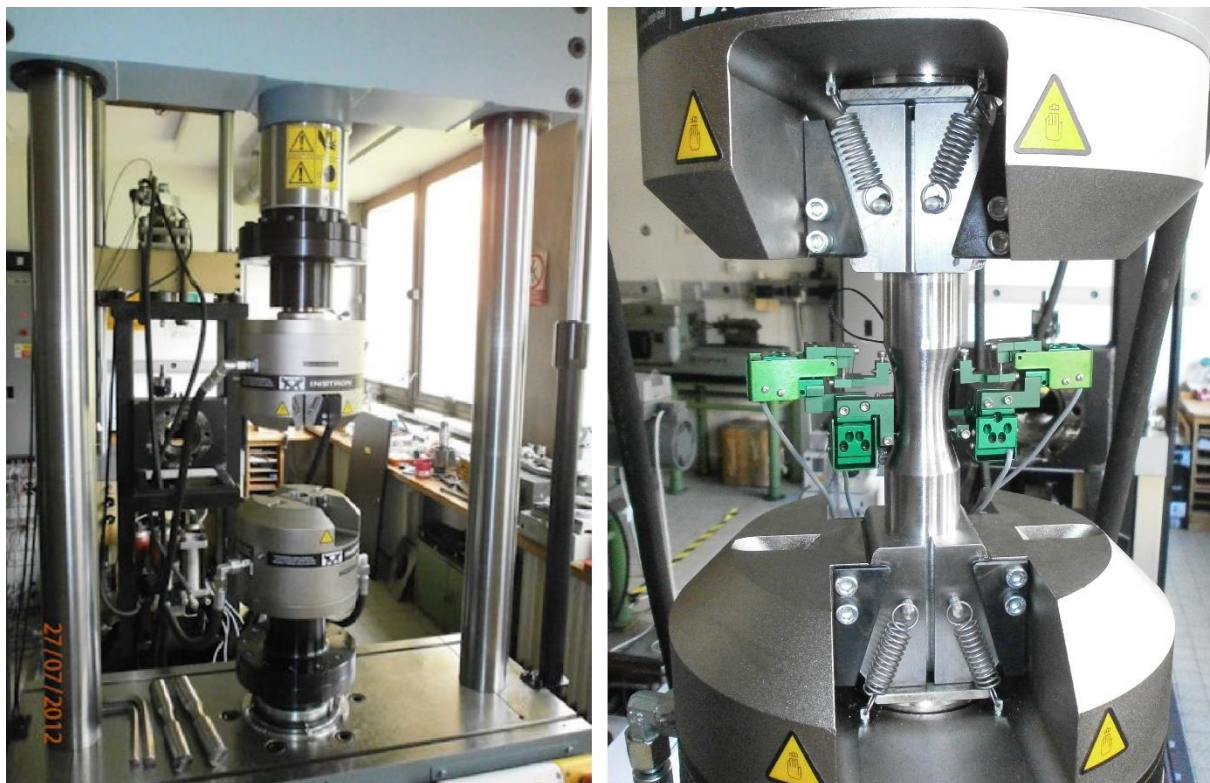
Obrázek 6 Zařízení MULTI-AX pro axiální a torzní namáhání [12]
