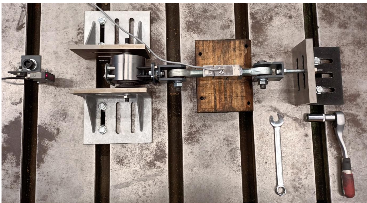
Obrázek 57 Sestava s větším převodníkem síly do 20 kN
