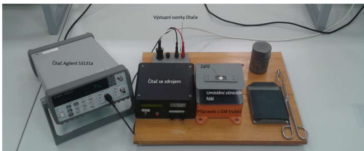
Obrázek 3.4 – Zapojení experimentu s použitím čítače
