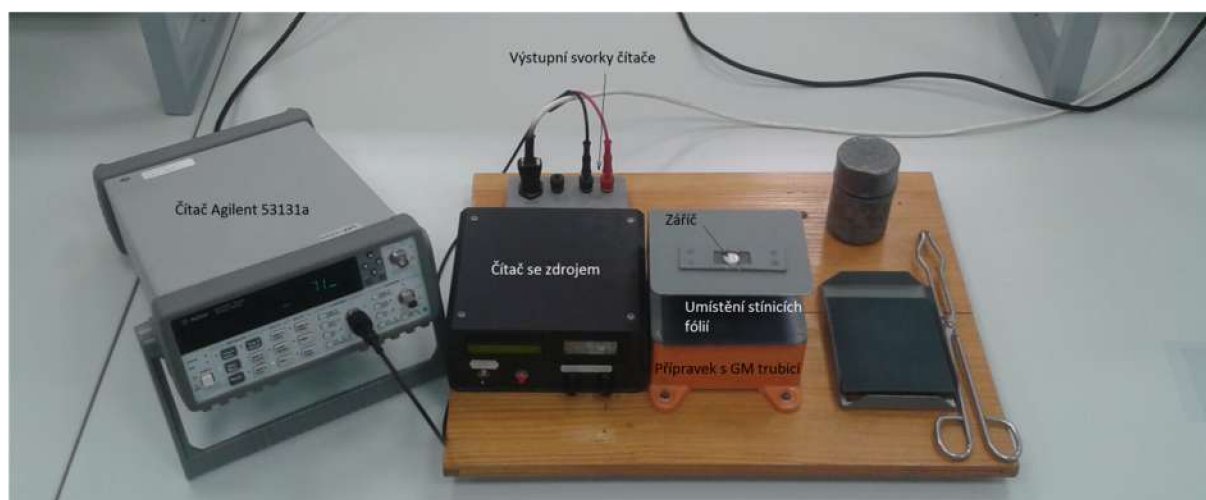
Obrázek 3.4 – Zapojení experimentu s použitím čítače
