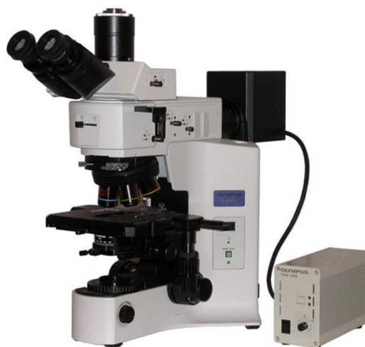
Obr. 8: Fluorescenční mikroskop Olympus BX 41 (Labx.com).
