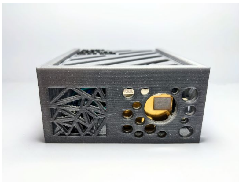
Obrázek 4.2: Detailní pohled na větrací otvory pro senzory teploty a koncentrace CO 2
