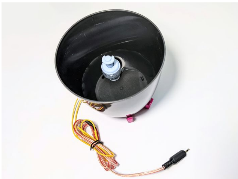
Obrázek 4.6: Nádržka na vodu se senzorem hladiny vody
