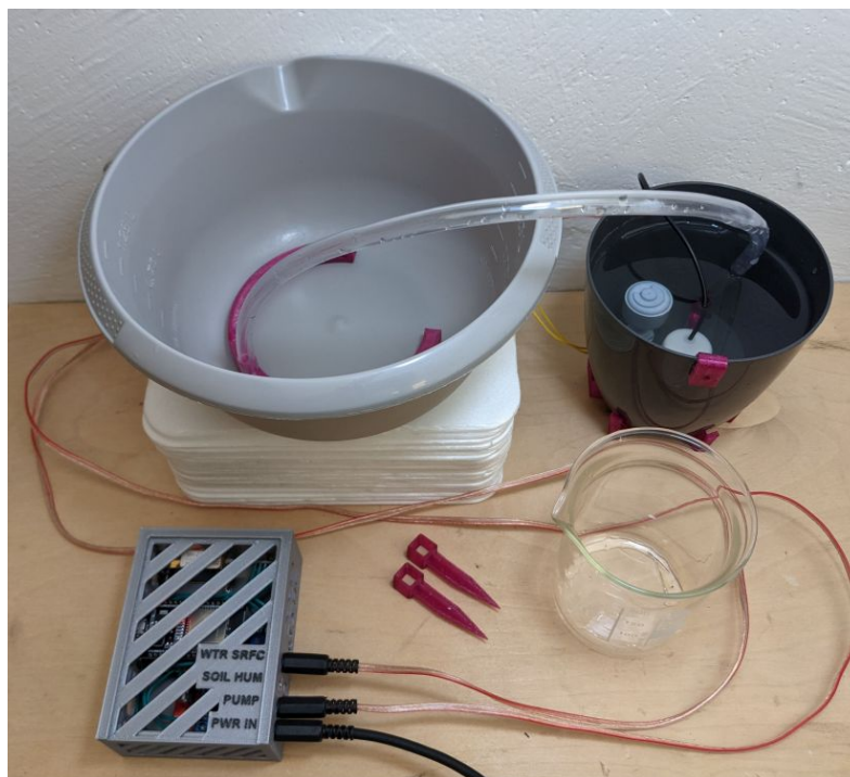
Obrázek 4.13: Sestava pro určení objemu vytečené vody v závislosti na čase čerpání
