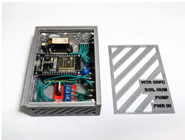
Obrázek 4.5: Pohled na uspořádání elektroniky v krabičce
