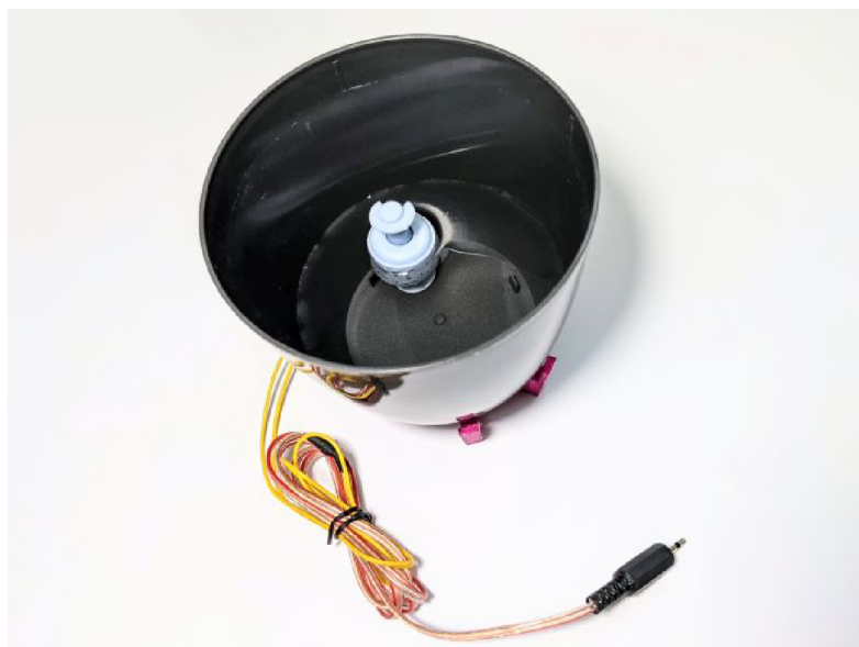
Obrázek 4.6: Nádržka na vodu se senzorem hladiny vody
