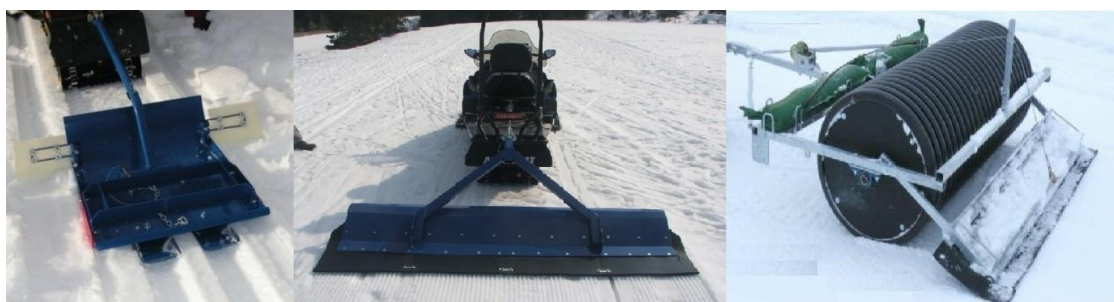
Obrázek č. 10: Zařízení pro výrobu běžeckých stop, zleva stopař, finišer, válec + finišer ( www.snezneskutry.cz , www.ctyrkolky-bce.cz )
