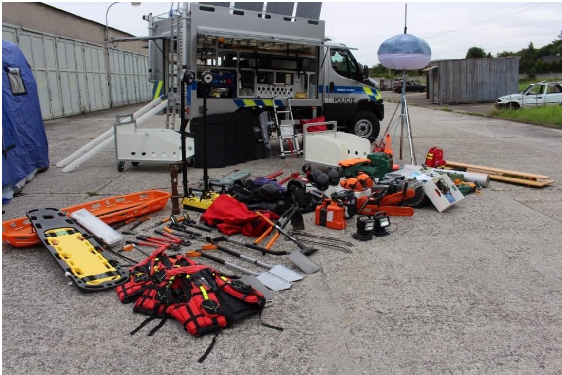
Obrázek 9: Vybavení speciálního technického vozidla Iveco Daily SPJ Moravskoslezského kraje.
