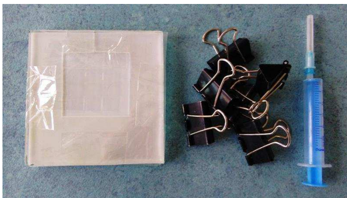
Obrázek 15 - Sada skel, svorky, stříkačka pro napouštění smíchané směsi
