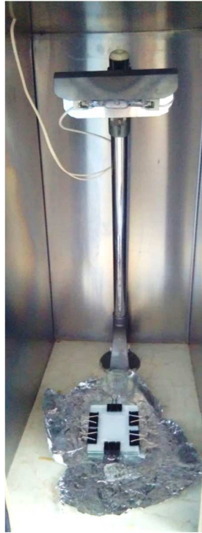
Obrázek 17 - Vytvrzovací UV komora
