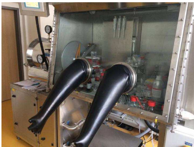
Obrázek 14 – Rukavicový box napuštěný argonovou atmosférou pro přípravu gelů
