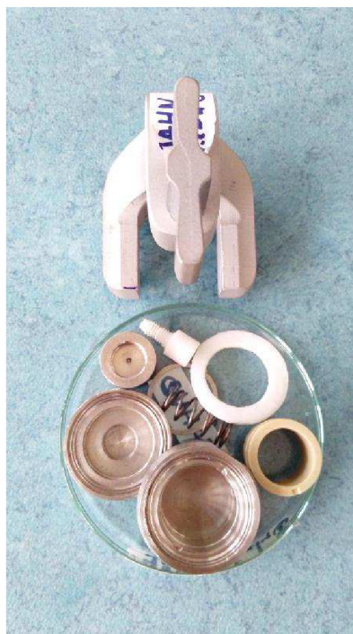
Obrázek 18 – Rozložená kovová cela, do které je vložen gel
