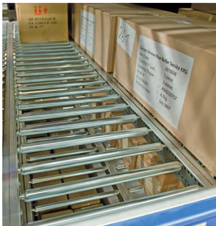
Obr. 28 Detail segmentu zvolené varianty válečkové dráhy [23].
