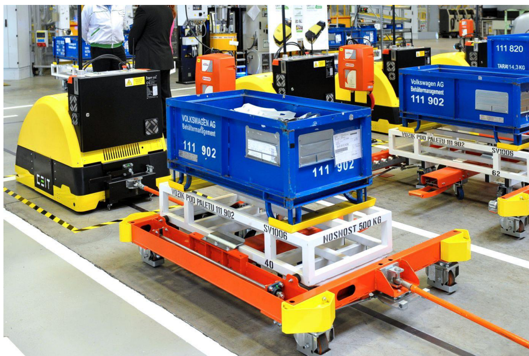
Obr. 26 Tahač CEITruck s připojenými vagony [20].
