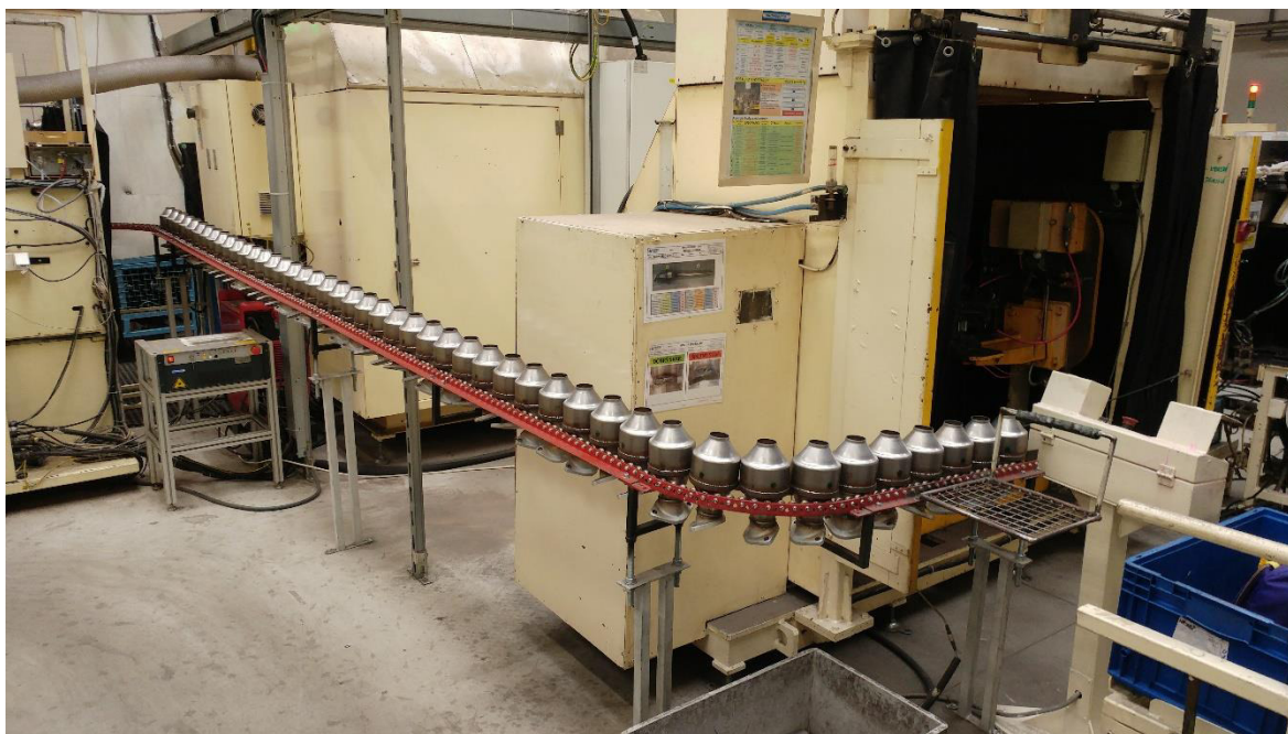
Obr. 13 Linka s gravitační válečkovou tratí.
