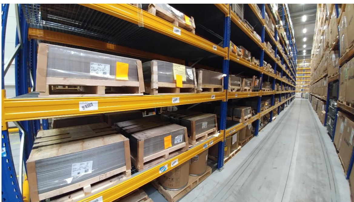
Obr. 8 Skladování plechových tabulí ve dvojřadovém příhradovém regálu.
