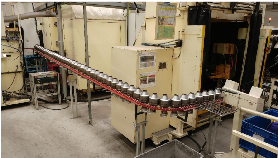
Obr. 13 Linka s gravitační válečkovou trati.
