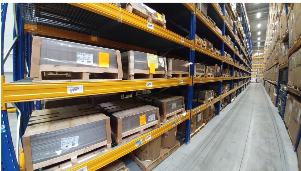
Obr. 8 Skladování plechových tabulí ve dvojřadovém příhradovém regálu.
