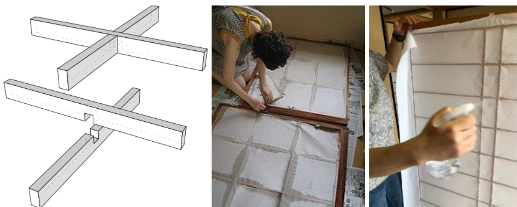
Obr.17 Spoje rámu, vyplňování a napínání papíru [43, 44, 45]
