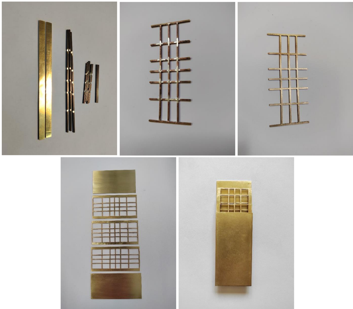
Obr. 36 Postup při tvoření chokeru
