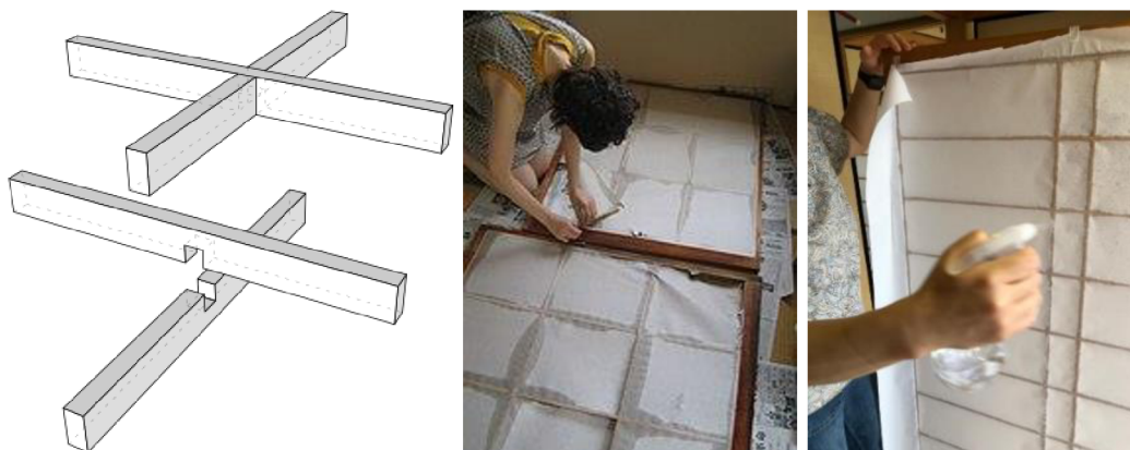
Obr.17 Spojení rámu, vyplňování a napínání papíru [43, 44, 45]
