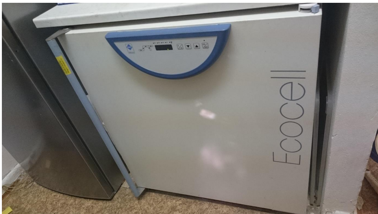
Obrázek č. 10: Sušárna ECOCELL s přirozenou cirkulací vzduchu
