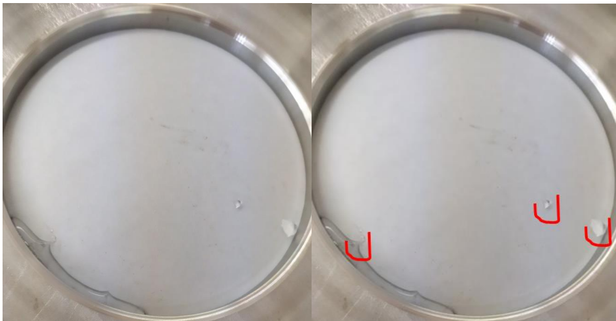
Obrázek 48: Testování vodního sloupce, konec testu průnik vody na třech místech
