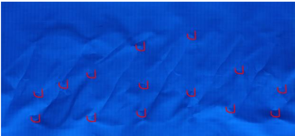
Obrázek 53: Označení některých trhlinek na materiálu T3 po 30 000 testech
