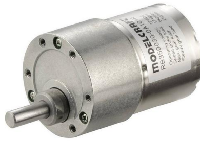
Obrázek 27: Motor 12V, převodový poměr 1:50, Ø motorku 35 mm, Ø převodovky-37 mm [34]
