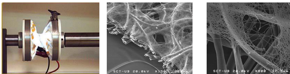
Obrázek 19: Přístroj Gelbo Flex testu a mechanické poškození nanovláknenné pavučiny po testování Gelbo Flex testu při různých zvětšeních [29]
