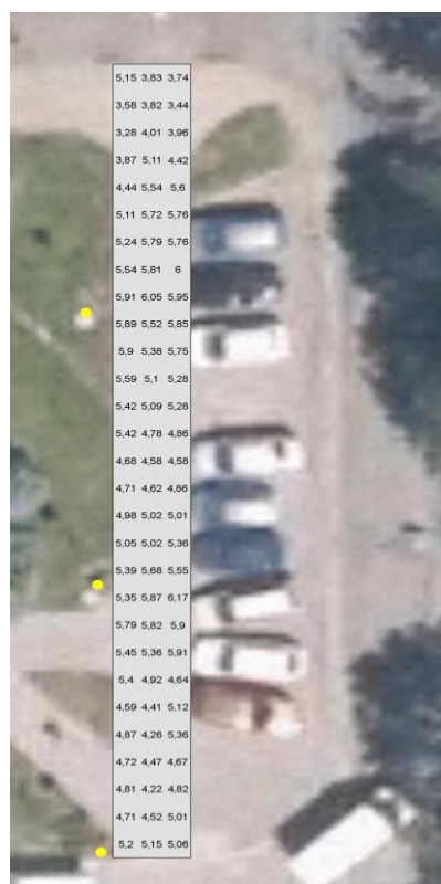
Obr. 63 Oblast 9 – naměřené hodnoty osvětlenosti
