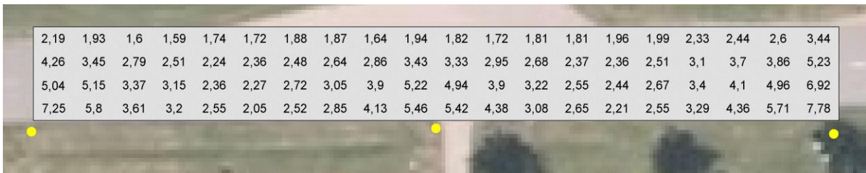
Obr. 23 Oblast 1 – naměřené hodnoty osvětlenosti
