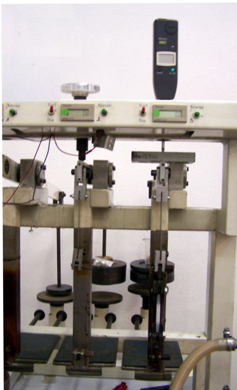
Obr. 19: Experimentální FNCT stanice
