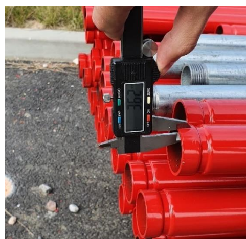
Obr. 13 Detail předpřipravených drážek. Foto autor
