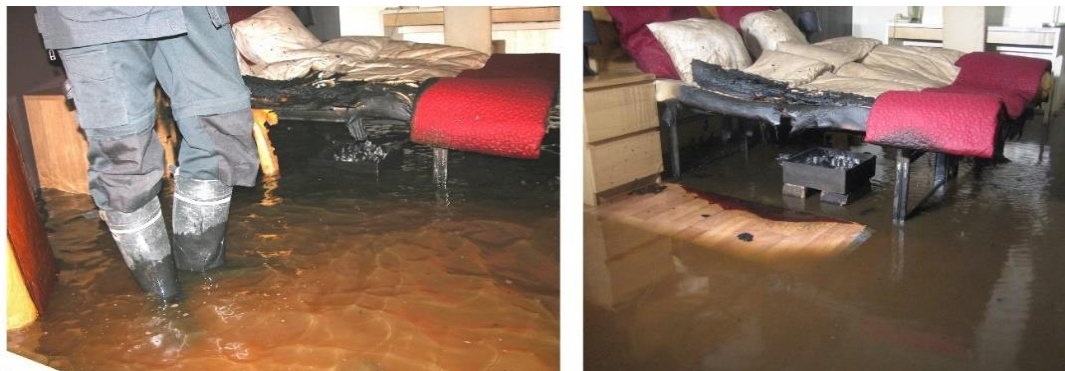
Obr. 28 Demonstrační zkouška hašení hotelového pokoje. Vlevo sprinklerovým SHZ a vpravo vysokotlakým mlhovým SHZ 54
