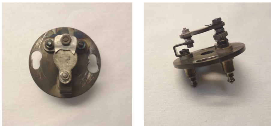
Obr. 5.1: Fotografie paletky s PBN topným tělískem a hroty pro uchycení vzorku do manipulátoru.
