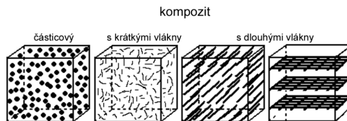
Obr. 5: Rozdělení kompozitů podle geometrického tvaru výztuže [25]
