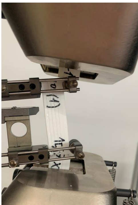
Obr. 5-2 Vzorka pretrhnutá na dvoch miestach súčasne
