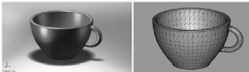
Obr. 2-1 Konverzia modelu na sieť trojuholníkov [1]
