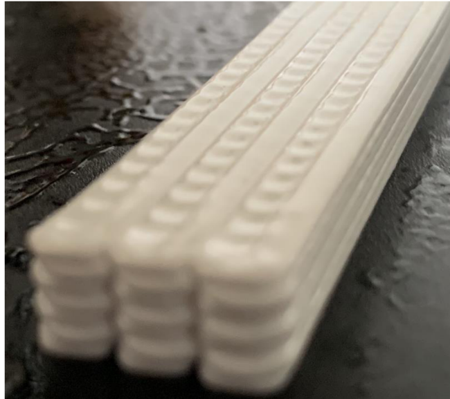
Obr. 6-1 Jav vibrácií tlačovej hlavy na vzorke
