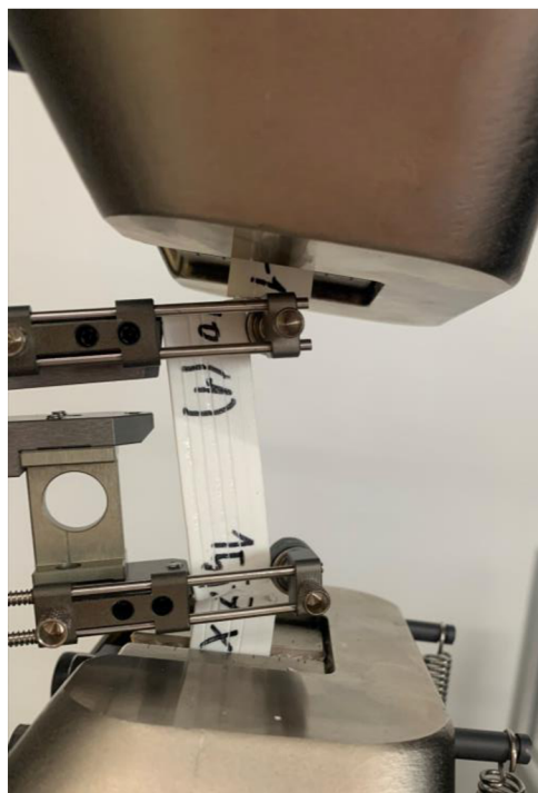
Obr. 5-2 Vzorka pretrhnutá na dvoch miestach súčasne
