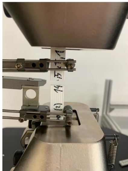
Obrázok 4-2 Testovaná vzorka s pripusteným extenzometrom
