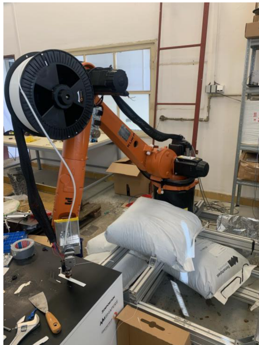
Obr. 4-3 KUKA KR8 R1620 pri tlači
