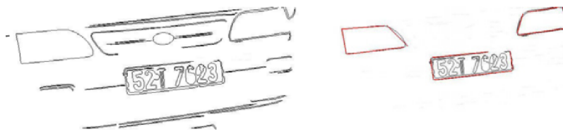
(b) Ukázka špatné detekce, kdy jsou za registrační značky považována i světla vozidla.
