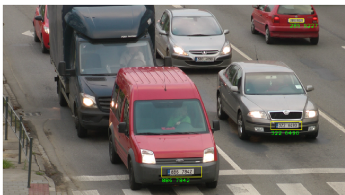
Obrázek 5.7: Ukázka výstupů celého systému detekce a rozpoznání registrační značky vozidel. Tyto výstupy obsahují chyby zapříčiněné špatným rozpoznáním symbolu, nenatrénováním daného znaku abecedy nebo nenalezením registrační značky.
