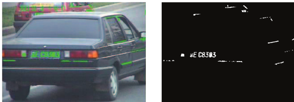
Obrázek 2.6: Detekce MSER regionů. Vlevo jsou zakresleny MSER regiony do vstupního snímku. Vpravo jsou regiony zakresleny do binárního obrazu. Převzato z [22].
