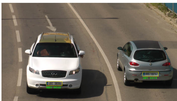
Obrázek 5.6: Ukázka správných výstupů celého systému detekce a rozpoznání registrační značky vozidel.
