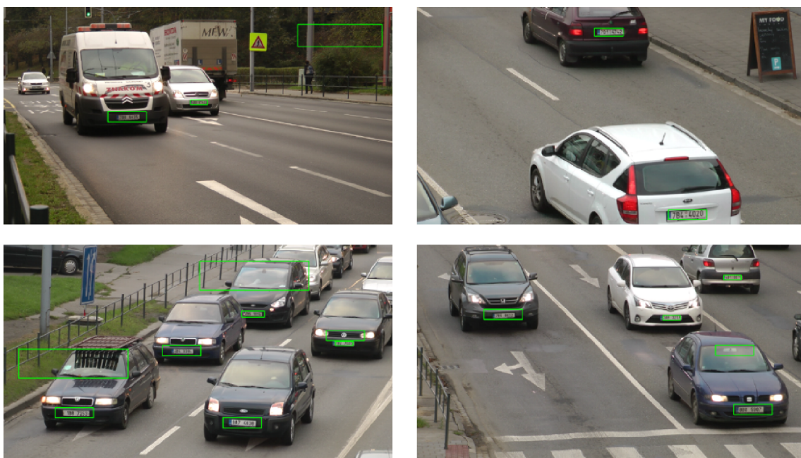
Obrázek 5.2: Detekce registračních značek pomocí kaskádového klasifikátoru.
