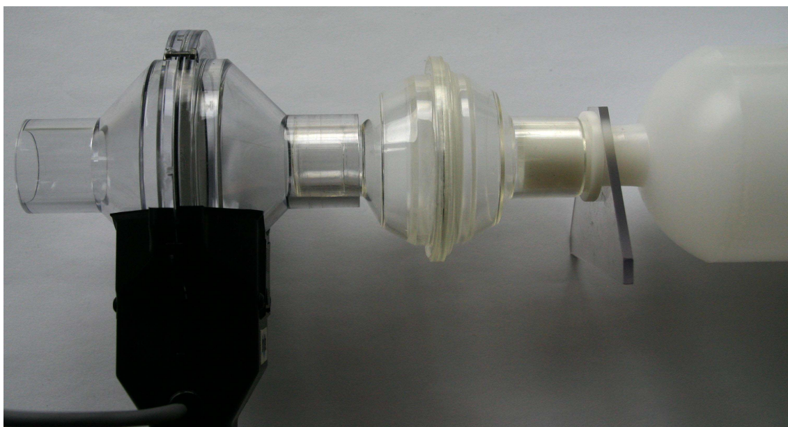
Obr. 6.4: Kalibrace snímače pomocí pístu.
