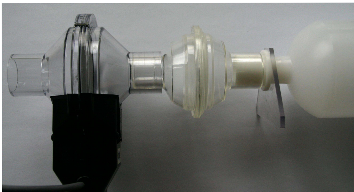
Obr. 6.4: Kalibrace snímače pomocí pístu.
