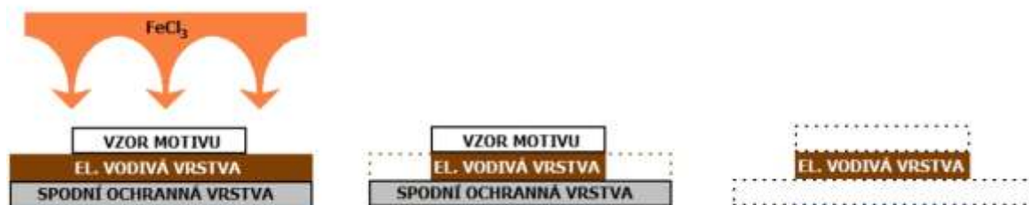
Obr. 16. Princip vyleptání anténního vzoru [3].
