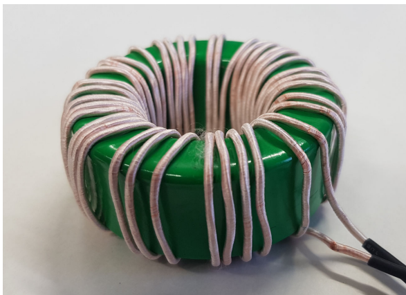
Obr. 7.34: Hotové primární vinutí transformátoru na toroidním jádře
