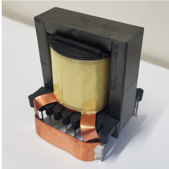
Obr. 7.11: Hotový transformátor na jádře ETD4415 s vinutím tvořeným tenkým páskem. Sekundární vinutí je zkratováno propojem.
