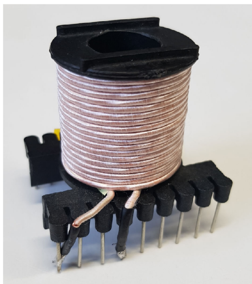
Obr. 7.33: Realizace vinutí transformátoru na kostru pro jádro ETD4415
