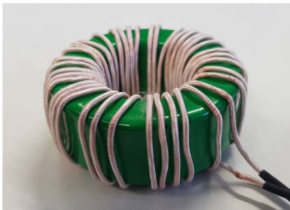
Obr. 7.34: Hotové primární vinutí transformátoru na toroidním jádře
