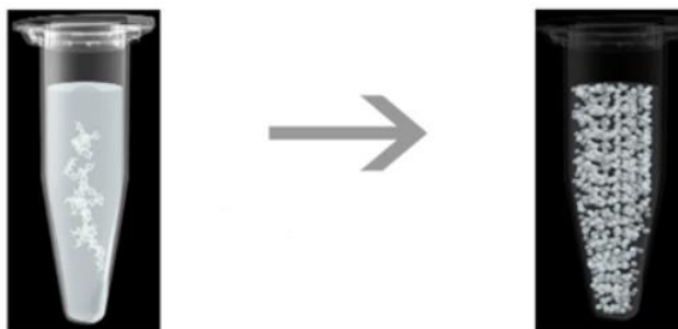
Obrázek 15: Rozdělení reakční směsi na kapičky ( https://www.bio-rad.com/en-cz/life-science/learning-center/introduction-to-digital-pcr/what-is-droplet-digital-pcr?ID=MDV31M4VY )
