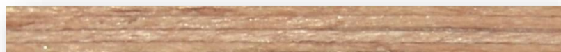
Obr. 38 Detail na 2mm vrstvenú BK dyhu použitú na skúšobné vzorky (vlastný zdroj)
