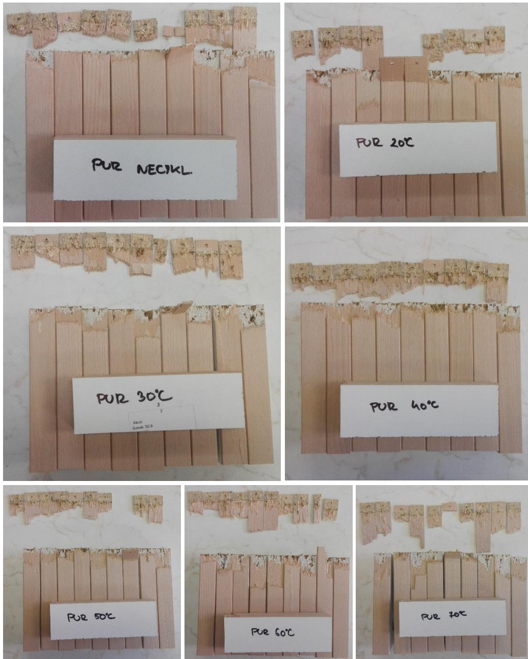
Obr. 88-94 Vzorok, ktoré prešli skúškou v odlupovaní pod uhlom 90°, pričom BK hrana bola nalepená PUR tavným lepidlom
