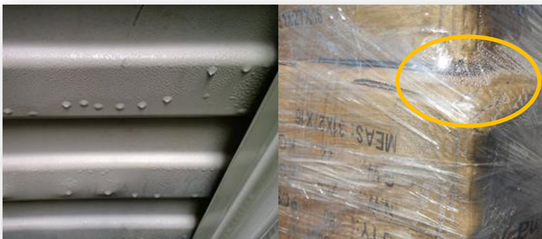
Obr. 45, 46 Obrázky kondenzácie na stropu kontajnera a priamo na obale prepravovaného tovar (zdroj: https://www.google.com/imghp?hl=sk )
