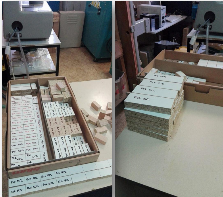
Obr. 59, 60 Proces delenia a označovania skúšobných vzoriek (vlastný zdroj)
