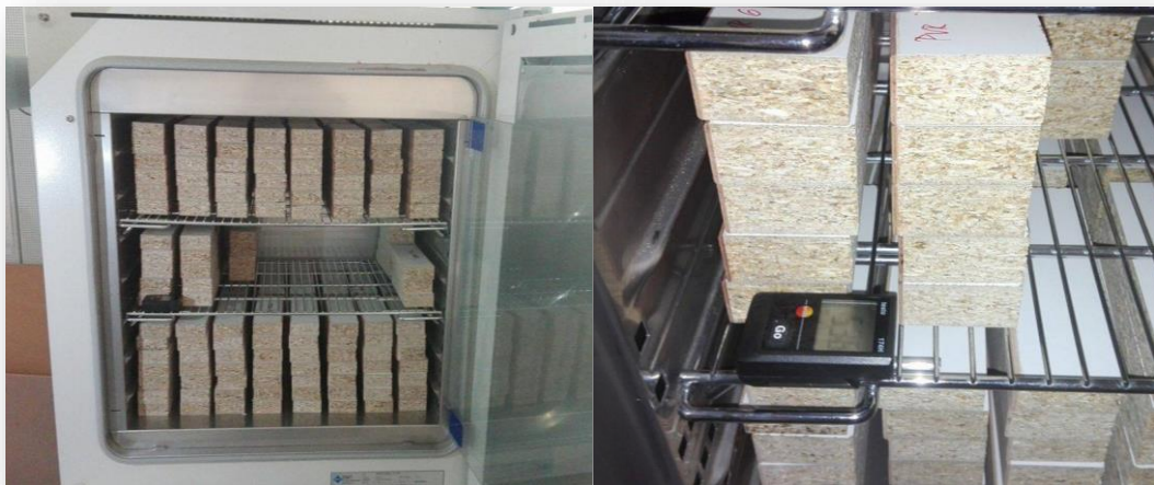
Obr. 62, 63 Vzorky a teplotný datalogger uložené v klimatizačnej komore INCUCCELL
