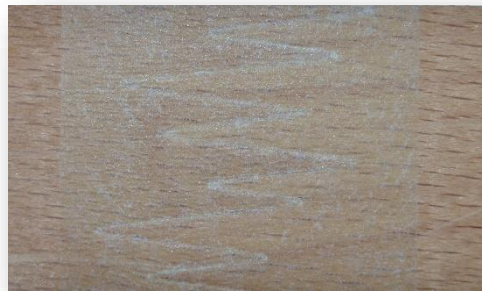
Obr. 37 Detail prstového spoja zaisteného pomocou pásky z flisu (vlastný zdroj)
