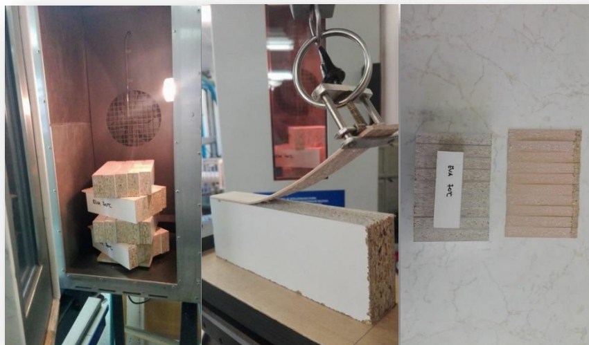
Obr. 67, 68, 69 Predhriatie vzoriek v komore, umiestnenie vzorky na skúšobný agregát a zahájenie skúšky, vyhodnotenie výsledkov (vlastný zdroj)
