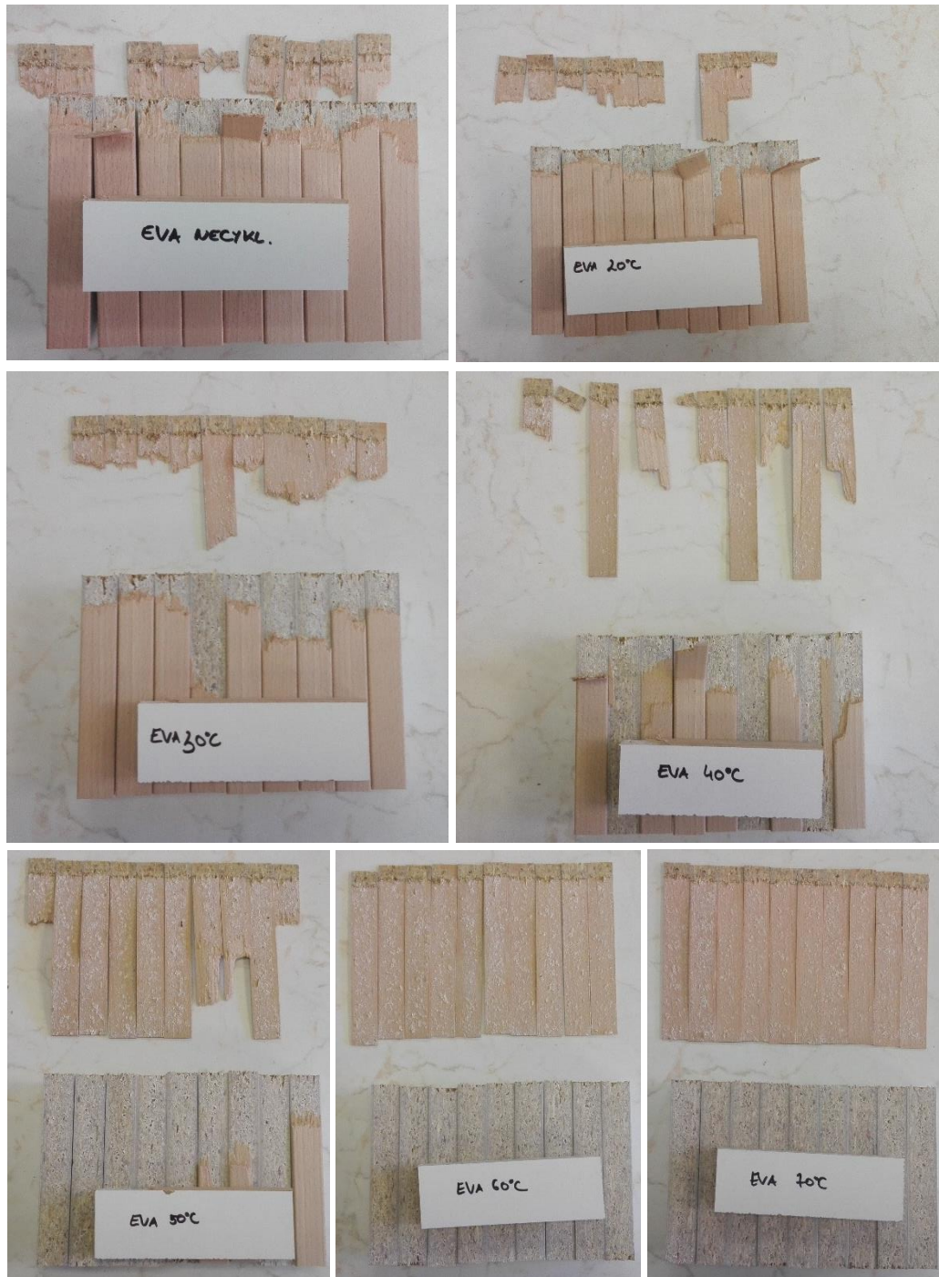
Obr. 80-87 Vzorky, ktoré prešli skúškou v odlupovaní pod uhlom 90°, pričom BK hrana bola nalepená EVA tavným lepidlom
