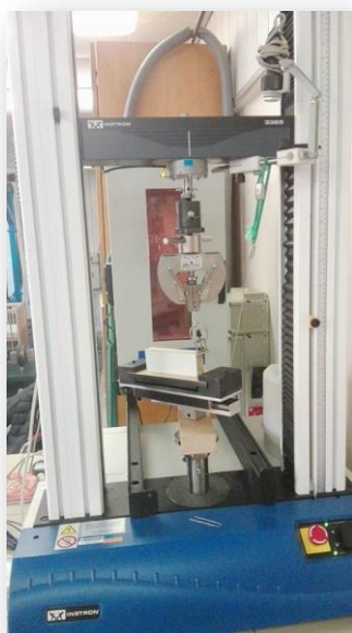
Obr. 66 Skúšobný agregát pre skúšku odlupovania na skúšobnom stroji INSTRON (vlastný zdroj)
