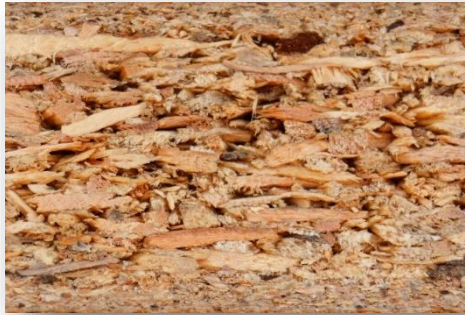
Obr. 39 Detail DTD dosky trojvrstvej (vlastný zdroj)
