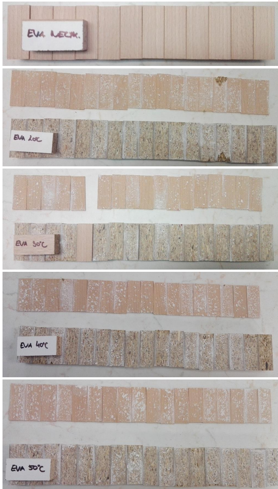
Obr. 100- 104 Vzorky, ktoré prešli skúškou šikmého smyku pri tlakovom zaťažení pod uhlom 45°, pričom hrana bola nalepená EVA tavným lepidlom
