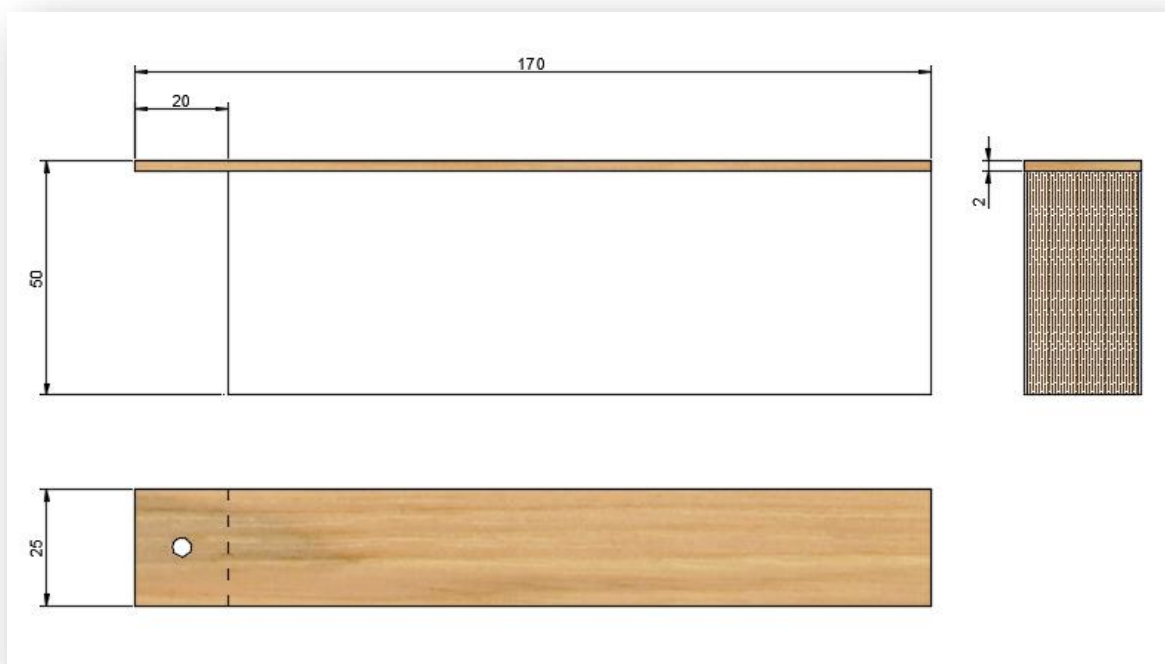
Obr. 58 Rozmery vzoriek na skúšku v odlupovaní (vlastný zdroj)
