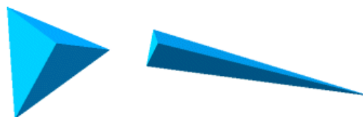
Obr. 35 Znárodnění rozdílu mezi čtyřstěnem s AR = 1 a AR=10
