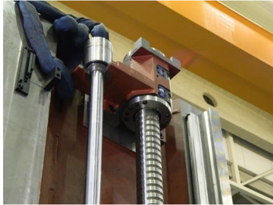
Obr. 28 Fotografie uchycení horního konce kuličkového šroubu do stojanu
