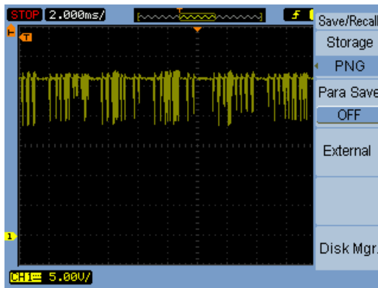
Obr. 4-5 Přenos dat na sběrnici CIB
