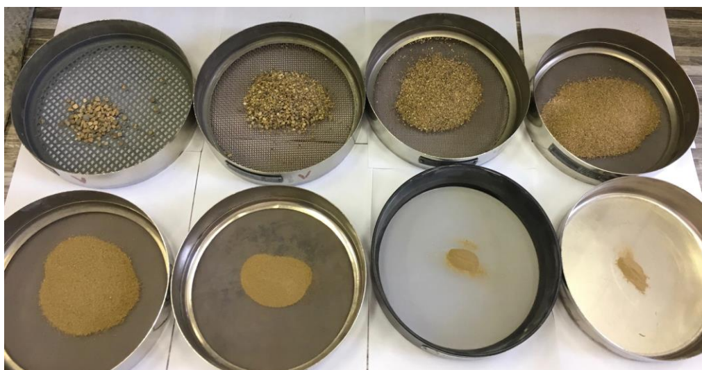
Obr. 29 Sítový rozbor písku z lomu Žabčice frakce 0–4 mm
