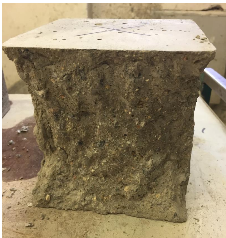
Obr. 38 Fotodokumentace porušení při zkoušce pevnosti v tlaku
