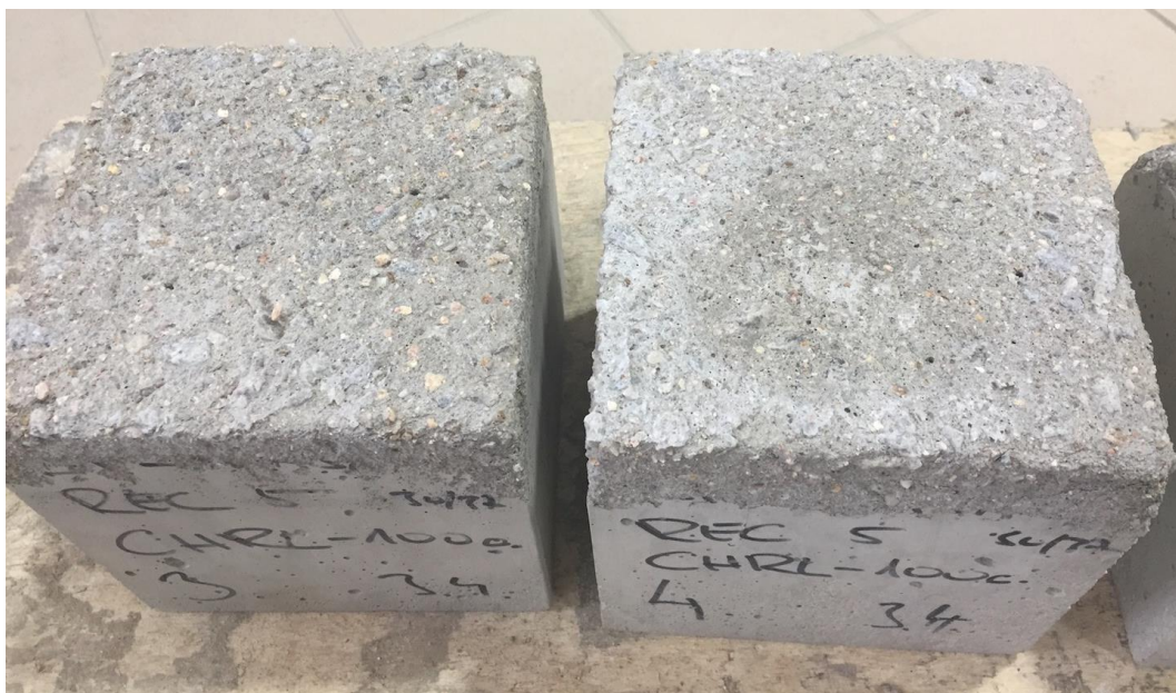
Obr. 40 Fotodokumentace po zkoušce CHRL – REC6
