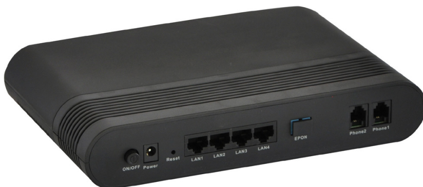
Obr. 2.1: Konektorová výbava klientské optické síťové jednotky ONU.
