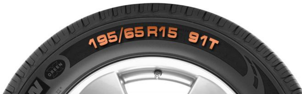
Obrázek 11: Označení rozměru a dalších informací o dané pneumatice
