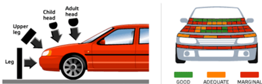
Obrázek 4: Schéma testů zabývajících se ochranou chodců
