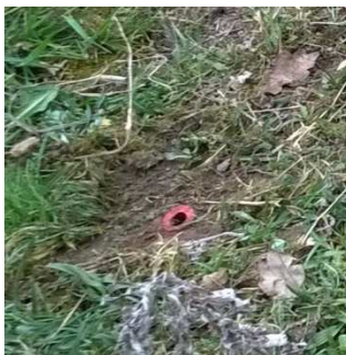
Obrázek č. 18: Stabilizace bodů pomocné měřické sítě
