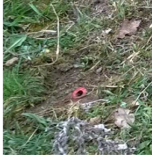
Obrázek č. 18: Stabilizace bodů pomocné měřické sítě
