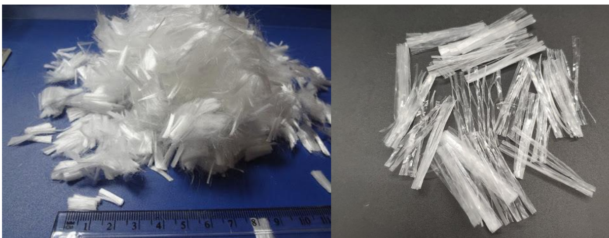
Obrázek 3: Monofilamentní polypropylenová vlákna (vlevo) a fibrilovaná polypropylenová vlákna (vpravo) [17]
