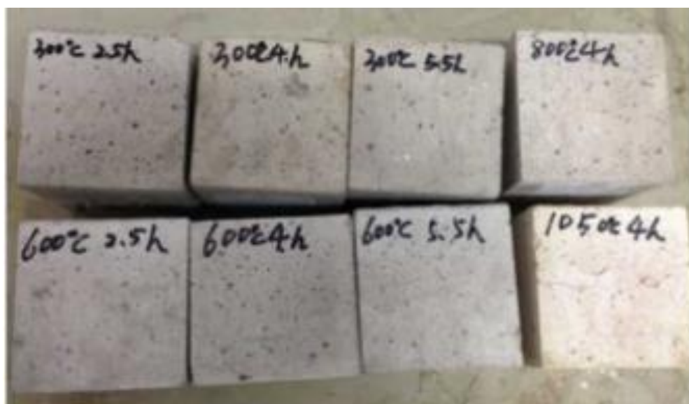
Obrázek 20: Vláknobeton s celulózovým vláknem po vystavení teplotnímu zatížení při různých dobách výdrže [71]
