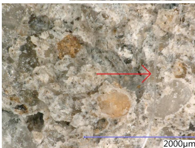
Obrázek 27: Mikroskopický snímek vláknobetonu s celulóзовými vlákny před působením vysoké teploty (nahore), PP vlákno ve struktuře betonu před působením vysoké teploty (dole vlevo), PP vlákno po působení vysoké teploty (dole vpravo)
