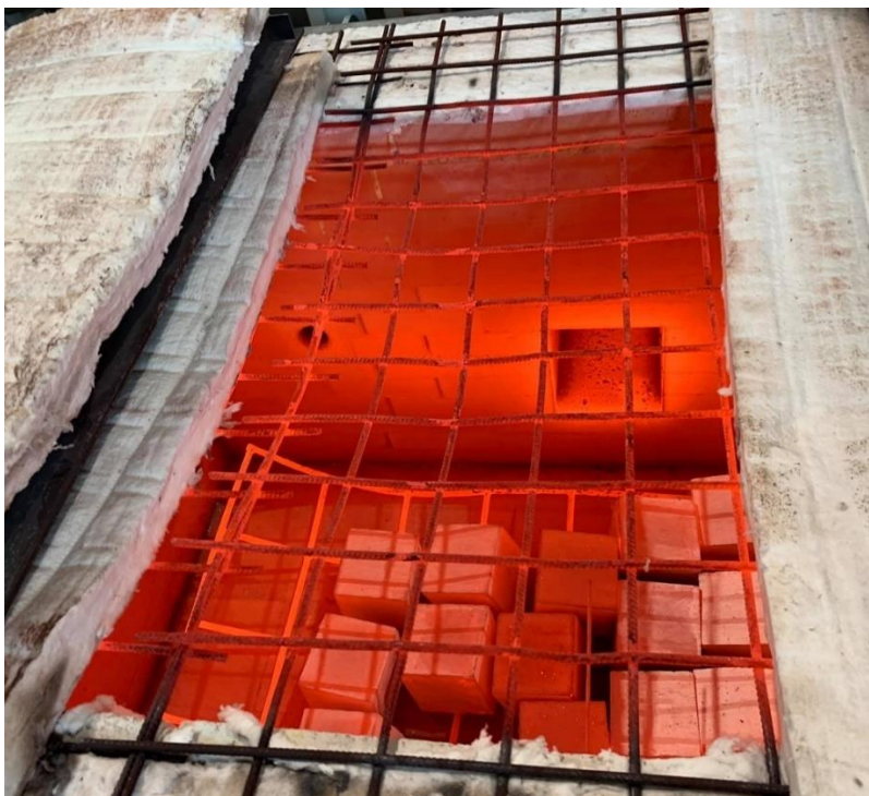
Obrázek 24: Zkušební tělesa v peci po ukončení zkoušky
