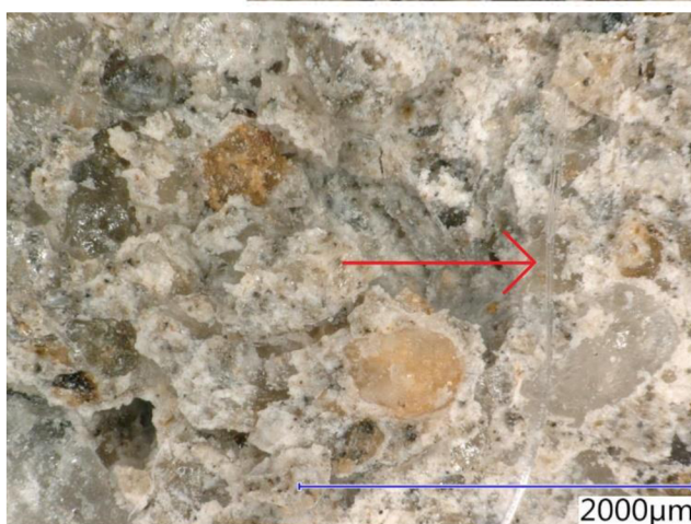
Obrázek 27: Mikroskopický snímek vláknobetonu s celulóзовými vlákny před působením vysoké teploty (nahore), PP vlákno ve struktuře betonu před působením vysoké teploty (dole vlevo), PP vlákno po působení vysoké teploty (dole vpravo)
