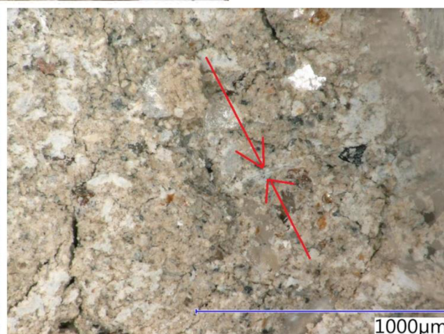
Obrázek 27: Mikroskopický snímek vláknobetonu s celulóзовými vlákny před působením vysoké teploty (nahore), PP vlákno ve struktuře betonu před působením vysoké teploty (dole vlevo), PP vlákno po působení vysoké teploty (dole vpravo)
