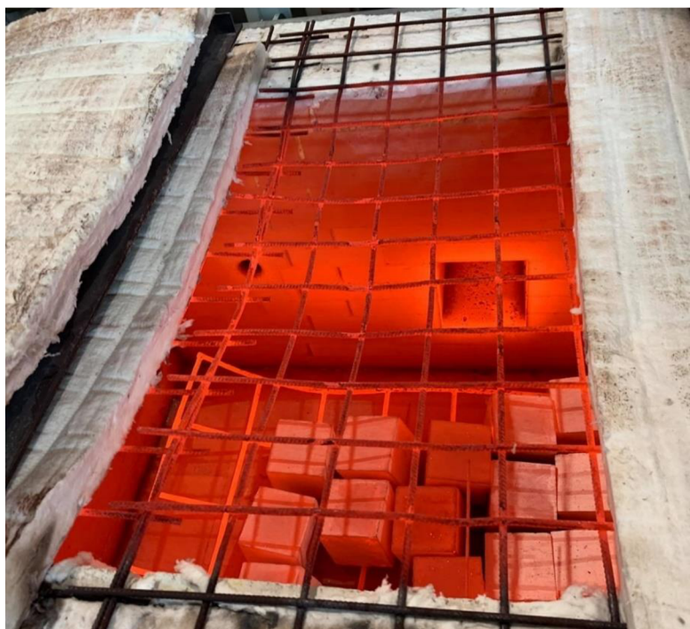
Obrázek 24: Zkušební tělesa v peci po ukončení zkoušky
