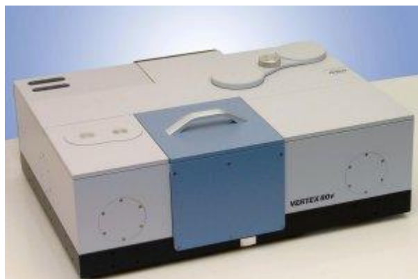
Obr. 20: FTIR spektrometr Vertex80v využívaný k identifikaci funkčních skupin v polymeru. [40]
