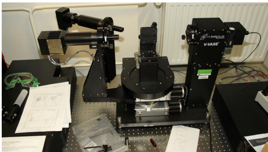
Obr. 19: Elipsometr V-VASE využívaný při měření tloušťky vrstvy. [39]
