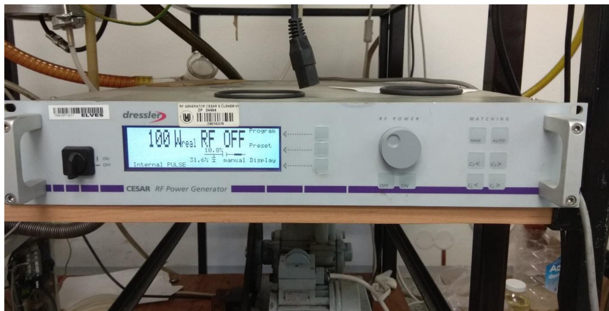
Obr. 12: Zdroj RF napětí Dressler Cesar 133.
