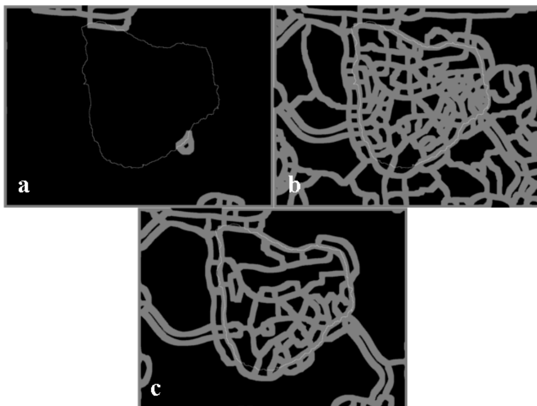
Obr. 19: Rozdělení do regionů na základě prahu t_{\text{mark}} , (a) příliš vysoký t_{\text{mark}} , (b) příliš nízký t_{\text{mark}} , (c) optimální t_{\text{mark}}
