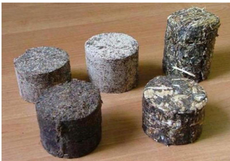
Obr. 20 Vylisované brikety; vzadu zleva: separát a dřevěné piliny 1:1, separát a dřevěné piliny 3:7, separát a seno 1:1, vpředu zleva: čistý separát a separát s topolovou štěpkou 1:1 [22]
