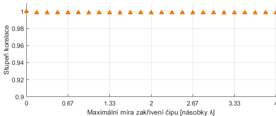
Obrázek 5.8: Míra korelace referenčního obrazce s obrazci generovanými v uspořádání s proměnným zakřivením povrchu
