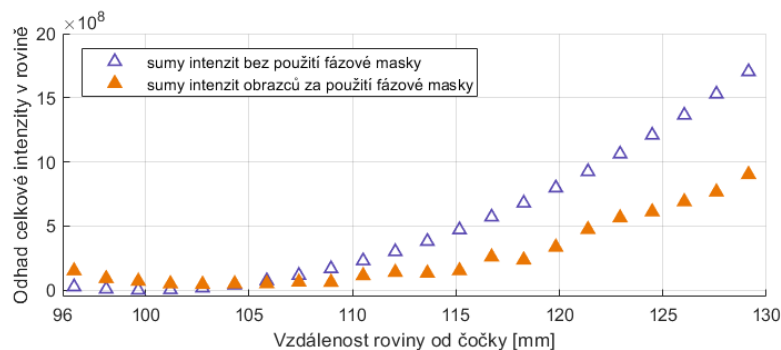
Obrázek 4.9: Odhad polohy ohniska ze sum intenzit ve vypočítaných obrazcích vybraných rovin
