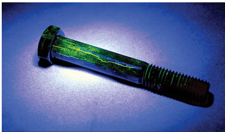
Obr. 3.5 Fluoreskacia chyby materiálu po ožiarení ultrafialovým svetlom [10]
