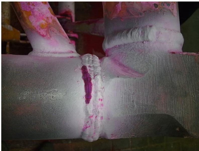
Obr. 3.3 Metóda farebnej indikácie pri určení vady zvarov [14]
